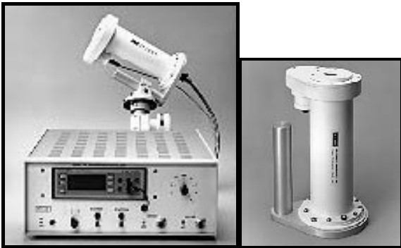
Figura 3.3 - Pireliômetros de Cavidade Absoluta
